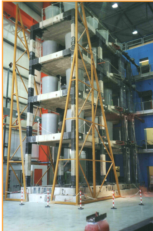
Commissione Europea Centro EURATOM Ispra ( VA ) Interventi di rinforzo strutturale con tessuti in fibra di Carbonio su edificio in C.A. da sottoporre a simulazione di terremoto.
